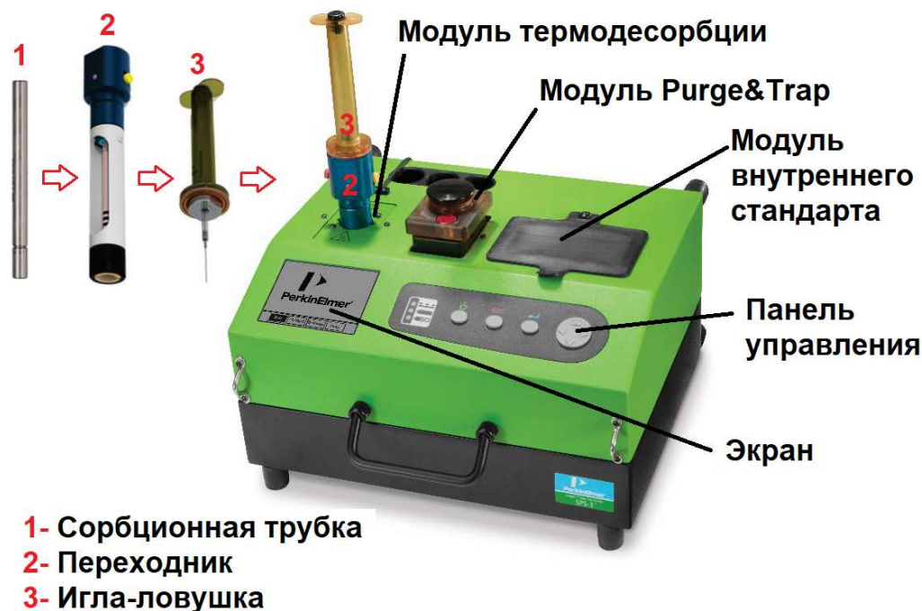
Рисунок 6. Портативная приставка для пробоподготовки SPS-3 (Sample Prep Station).
