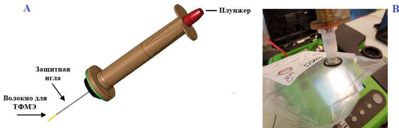
Рисунок 1. Шприц для ТФМЭ Custodion SPME (А) и отбор пробы из тедларового пакета (В). Шприц Custodion для ТФМЭ (SPME) состоит из волокна длиной 1 см, покрытого пленкой жидкого полимера, слоем твердого сорбента или их комбинацией; толщина покрытия составляет 50-100 мкм. Полимерная фаза SPME сорбирует вещества из воздуха, паровой фазы, жидкостей или растворенных
